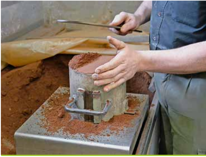
A chaque coulée hebdomadaire, 30 à 40 cloches sont fabriquées. Les moules, faits de sable d'argile, sont détruits par le processus, mais le sable est réutilisé.
