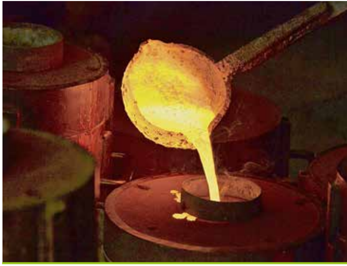
Tel de la lave, le métal en fusion est versé dans l'interstice entre le moule intérieur et le moule extérieur. Pour les plus grosses cloches, le creuset rougeoyant est sorti du four.
