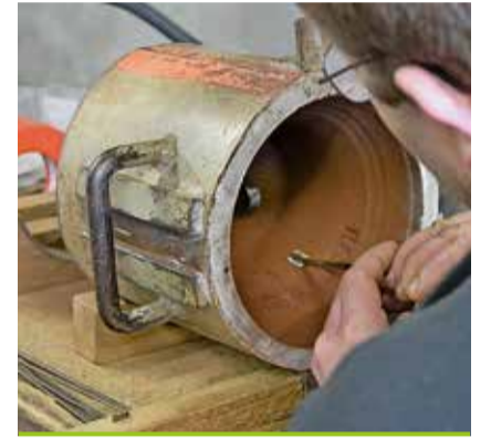
Concentration maximale: les décors sont réalisés à l'envers.
