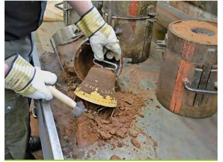
Quelques coups de marteau sur les moules permettent de faire apparaître la cloche au milieu du sable. Il faudra encore brosser, polir, ajouter le battant et la courroie.
