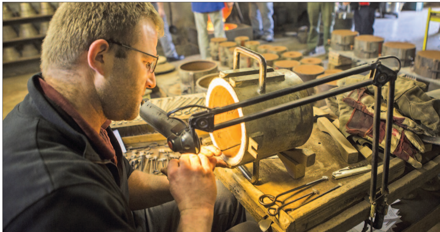
Dans la fabrication des cloches en bronze, la préparation du moule et le marquage représentent le gros du travail. CHLOË LAMBERT
