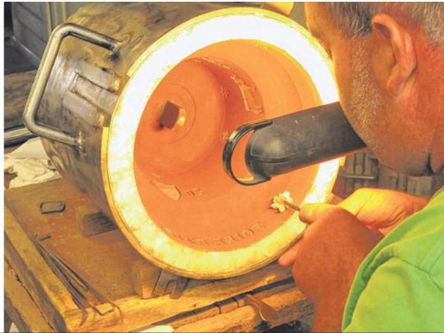
Le moule de sable est soigneusement imprimé des motifs en négatif. L'étape est minutieuse.
